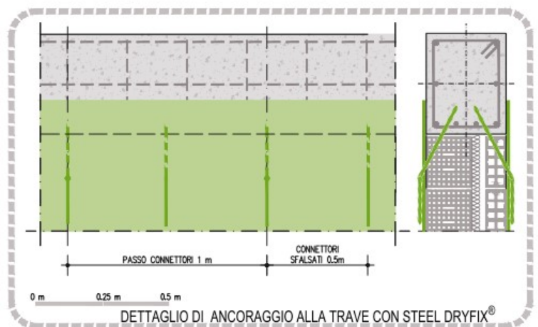
PROSPETTO RINFORZO DELLA TAMPONATURA TRAMITE GEO GRID 120 IN ABBINAMENTO A GEOALCE F ANTISISMICO E BARRE IN ACCIAIO INOX
