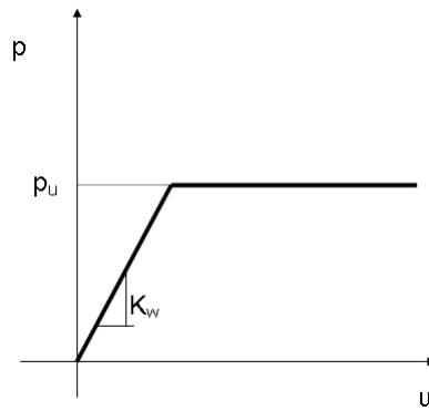
Il legame di tipo elastoplastico reagente a sola compressione è ottenuto utilizzando come rigidezza all'origine la costante di *Winkler* del terreno e come resistenza il valore della capacità portante ultima calcolata con le normali teorie di *Brinch-Hansen* e *Vesic*. Il modello così ottenuto è in grado di tenere in conto dell'eterogeneità del terreno in maniera puntuale.
