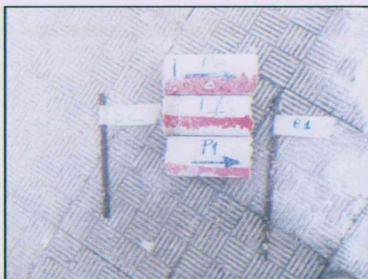
**Fig. 2** – Carote e barre di armatura estratte
